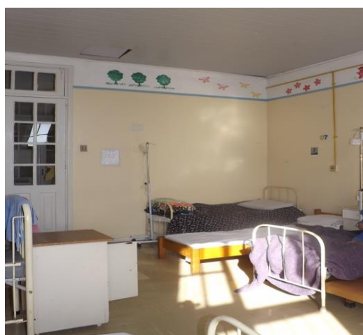
Figura 5.4 - Ambientes do hospital Santa Casa de Pelotas, RS. a) Enfermaria 292; b) Posto de Enfermagem. Ambientes com pintura proporcionando o efeito cromático de redução da altura do pé direito alto, com uso de faixa na mesma cor do teto (branco).
