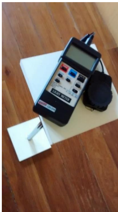
Figura 55 – Modelo de luxímetro utilizado nas medições lumínicas.
