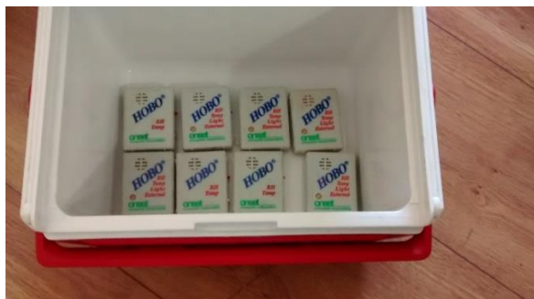
Figura 43 – HOBOS condicionados em caixa térmica para aferição.
