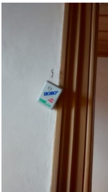
Figura 53 – Detalhe de fixação interna dos sensores.
