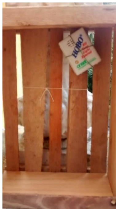
Figura 54 – Fixação em suporte de madeira do sensor externo.
