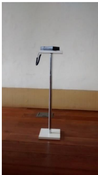
Figura 62 – Detalhe do luxímetro e suporte para medições a 75cm do piso.
