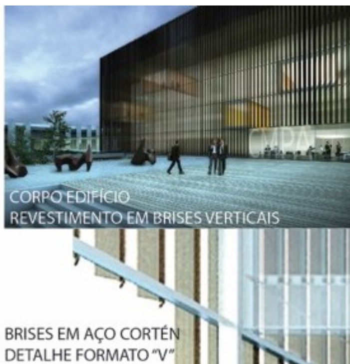
Figura 125: Brises verticais em ao cortén
