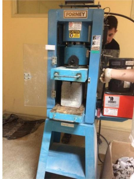
Figura 19: Realização do ensaio resistência à compressão – primeira etapa.
