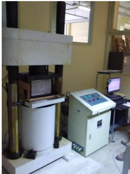
Figura 20: Realização do ensaio resistência à compressão – segunda etapa.
