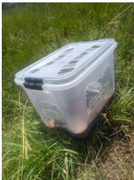
Figura 2 – Caixa plástica de armazenamento adaptada utilizada como armadilha contendo o atrativo (carcaças queimadas OU não queimadas).
