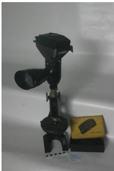
Figura 31 – Equipamento para obtenção de microfotografia da marca Carl Zeiss – Jena
