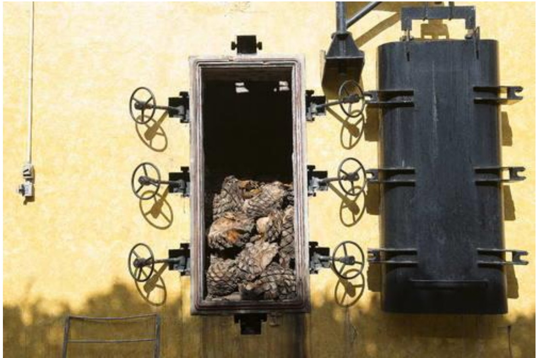
Figura 20: Hornos para la cocción de piñas de agave, como una de las primeras etapas de la elaboración del tequila. Fuente: (UNESCO, 2018c)
