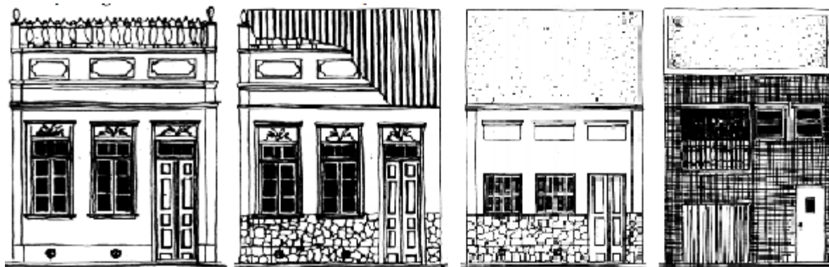
Figura 12 - Graus de descaracterização. Construção íntegra; Grau II, Grau III e Grau IV.
