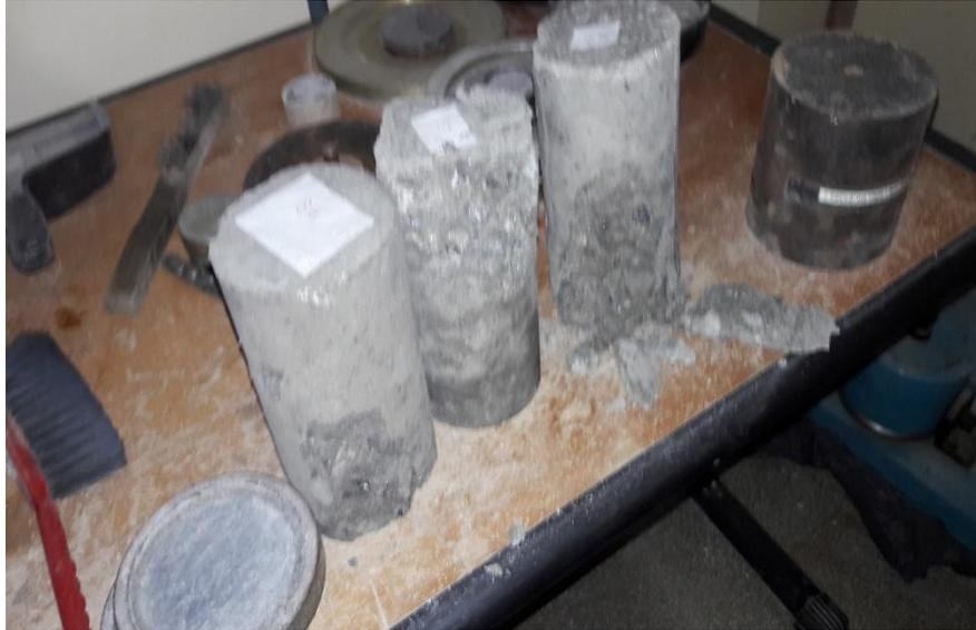
Figura 13 - Corpos de prova após ruptura
