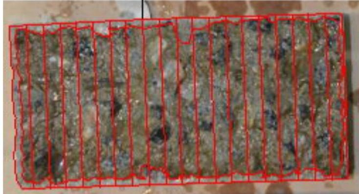
Figura 19- Ilustração da medida de profundidade de penetração de cloretos
