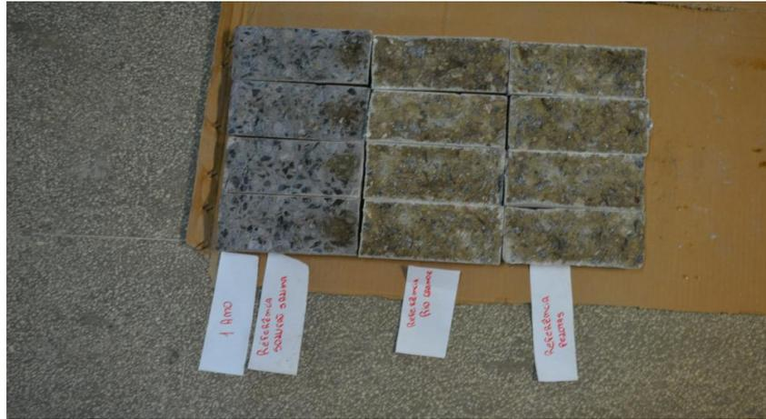
Figura 45 – Penetração de íons cloreto após 12 meses de exposição natural e imersão em solução salina
