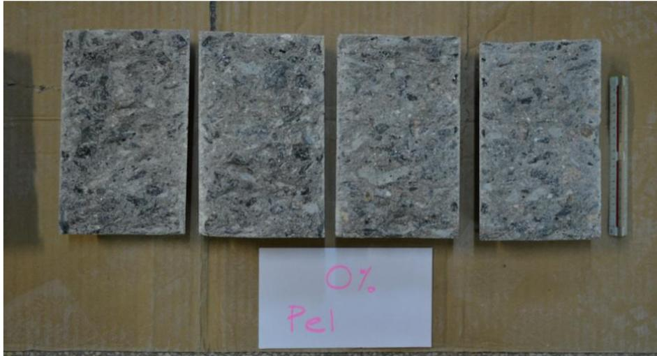
Figura 17 - Corpo-de-prova após ruptura por compressão diametral
