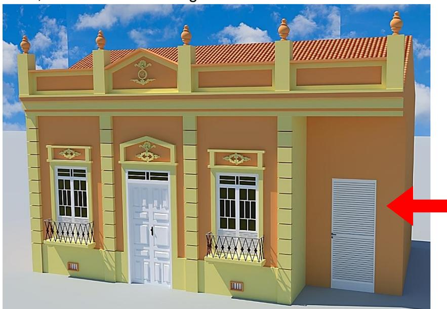
**Figura 28** – Ilustração de uma possibilidade de demolição parcial da fachada.
