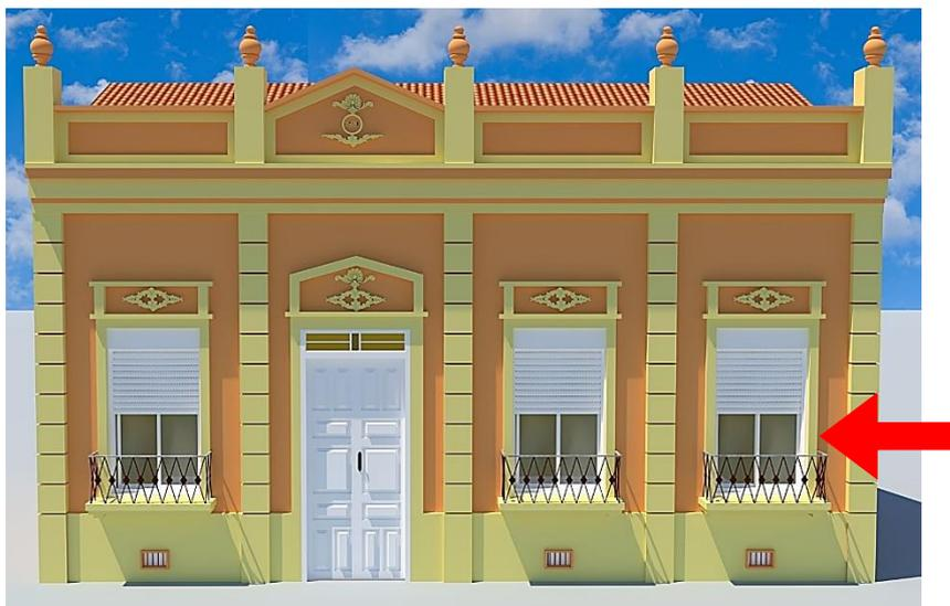
**Figura 32** – Ilustração de possibilidade de substituição de esquadrias mantendo a forma.
