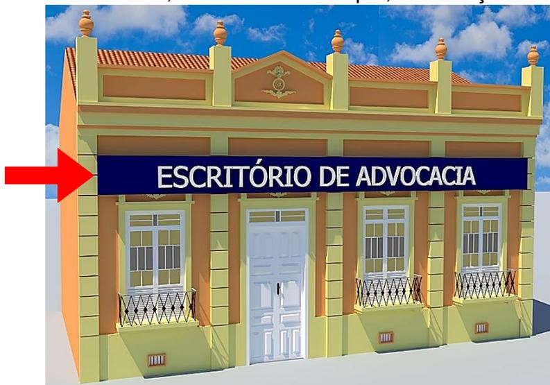
**Figura 54** – Ilustração de aparato publicitário inadequado sobre a fachada.
