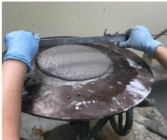
Figura 13: Verificação do índice de consistência da argamassa
