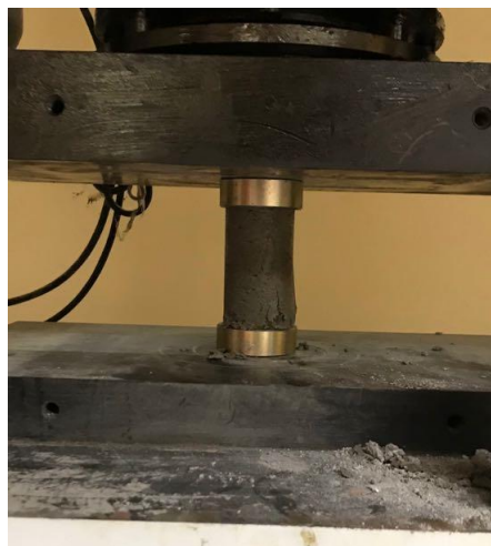
Figura 15: Corpo de prova na prensa mecânica sob ensaio de resistência à compressão axial com auxílio de regularizador de neoprene
