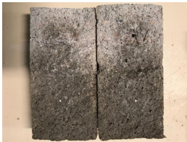
Figura 19: Corpo de prova rompido diametralmente após a absorção por capilaridade.
