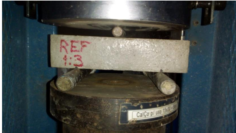
Figura 17: Rompimento do prismas de argamassa quanto a tração na flexão
