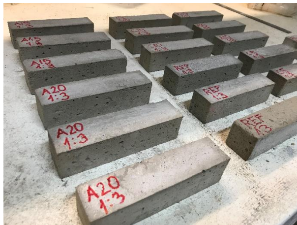
Figura 16: Corpos de prova para ensaio de tração na flexão após desmolde
