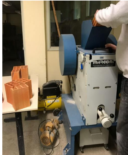
Figura 6: Beneficiamento em britador de mandíbulas
