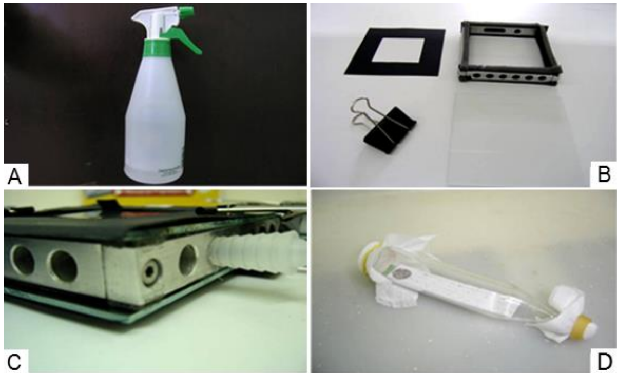
Figura 3 - Detalhes da condução dos bioensaios (seletividade/efeito). A) Pulverizador manual utilizado para aplicação da calda (testemunha positiva); B) Componentes utilizados na montagem da gaiola de exposição de T. pretiosum aos resíduos do inseticida e partes das plantas transgênicas a parasitoides de ovos; C) Detalhes do sistema de sucção de vapores tóxicos do interior da gaiola; D) Tubo de emergência contendo ovos de Anagasta kuehniella parasitados, adultos de T. pretiosum recém emergidos e filetes de mel. Pelotas-RS. 2011/2012.
