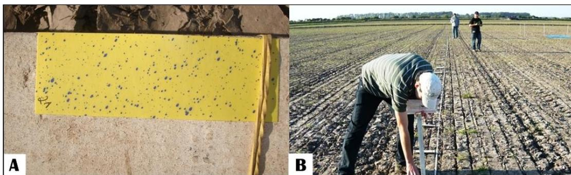
Figura 4 - Fixação do cartão hidrossensível sobre plataforma de madeira (A). Disposição dos cartões hidrossensíveis ao longo da parcela (B).
