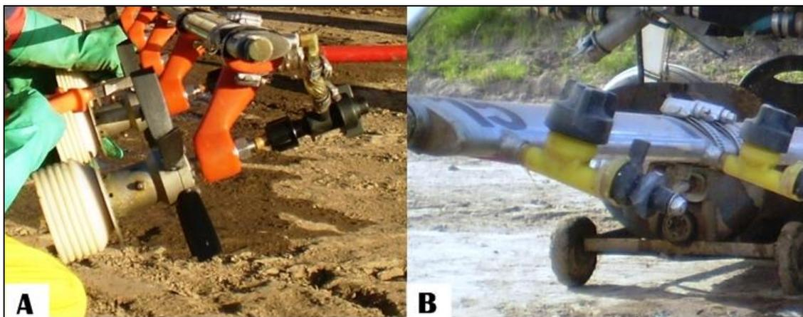
Figura 3 - Atomizador rotativo de discos (A). Bico defletor (B).
