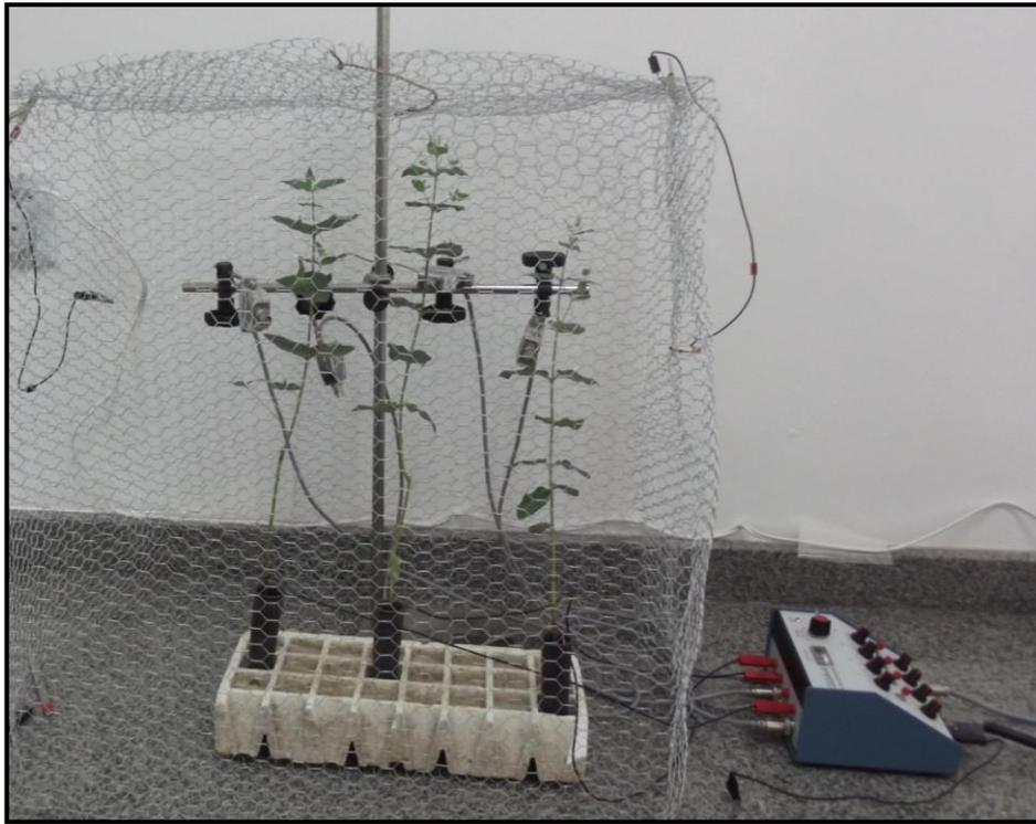
Figura 11 – “Gaiola de Faraday”, contendo no seu interior as plântulas de *Eucalyptus benthamii*, utilizada para redução das interferências durante os registros e ao lado o equipamento GIGA 4 – DC. Colombo-PR, 2012.
