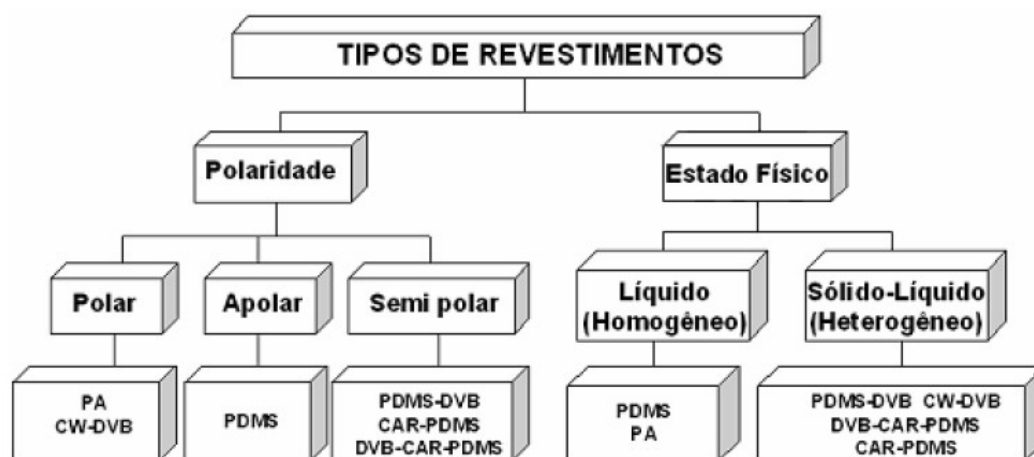
Figura 7: Esquema representativo da classificação dos revestimentos poliméricos comerciais para SPME
