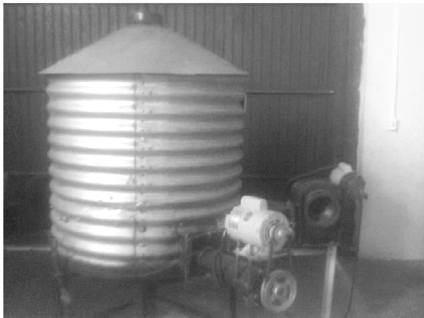
Figura 3. Silo-secador
