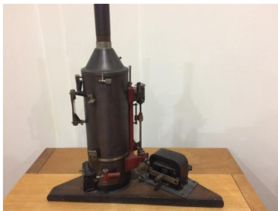
Figura 6: Réplica de gerador com caldeira.
