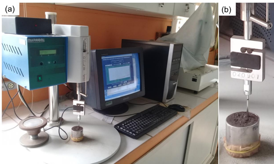
Figura 10 – Atuador eletrônico linear e a avaliação da resistência mecânica a penetração do solo. (a) vista geral do equipamento; (b) vista aproximada da inserção da haste na amostra. Fonte: Autor
