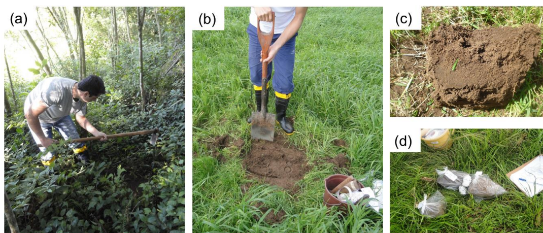
Figura 11 – Procedimento adotado para coleta de amostras deformadas ao longo da transecção da sub-bacia hidrográfica Micaela, Pelotas-RS: (a) remoção da vegetação da área superficial para o solo ser amostrado; (b) inserção da pá no solo para extrair a amostra; (c) amostra de solo removida e (d) amostras de solo embaladas e identificadas. Fonte: Autor
