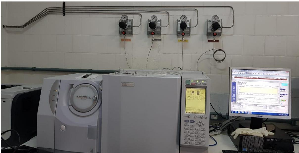
Figura 7 – Cromatógrafo gasoso acoplado à espectrômetro de massas localizado no Laboratório de Cromatografia e Espectrometria de Massas (LACEM) da UFPel
