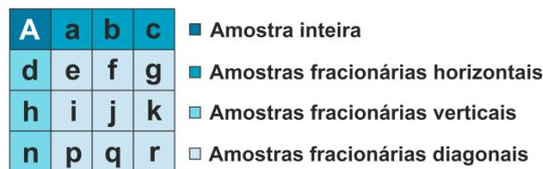
Figura 28 – Amostras fracionárias de acordo com suas posições em relação à amostra inteira. Adaptado de (PERLEBERG et al., 2018).
