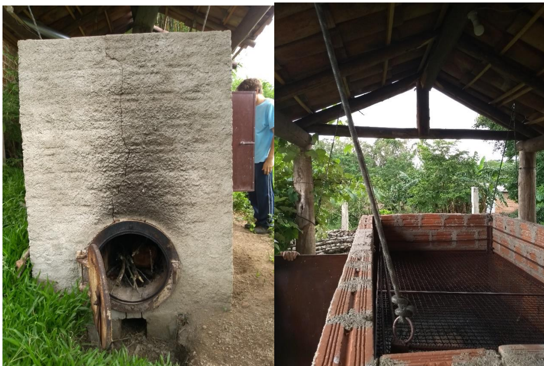
Figura 39 – Propriedade Agroecológica Schiavon. Secador/defumador feito pelo agricultor. Vista da fornalha (à esquerda); grelha de suporte das folhas de erva-mate, com sistema de sobe e desce (à direita) (2019).
