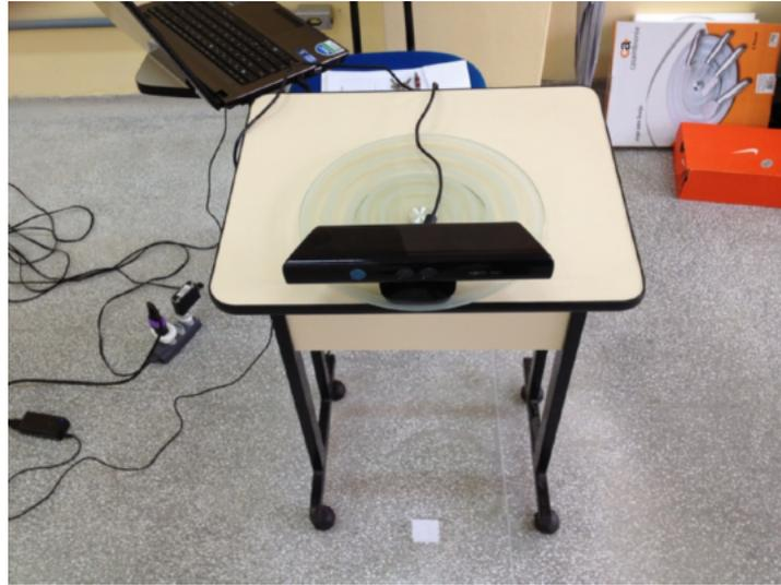
Figura 44: Microsoft Kinect com um disco giratório (prato rotativo) adicionando ao sensor o movimento panorâmico não presente no sensor.
