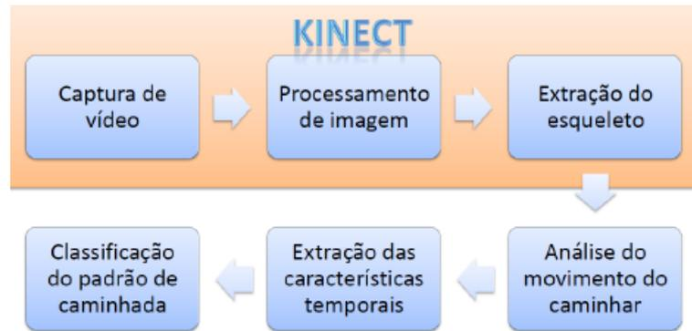
Figura 37: Pipeline da análise do caminhar humano com o uso do Kinect.
