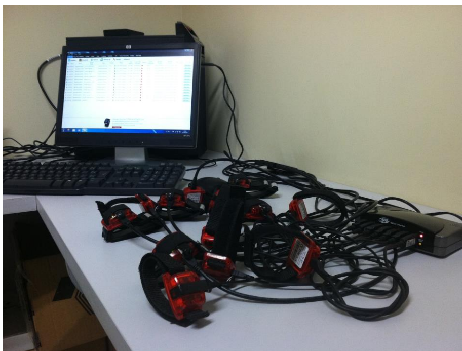
Figura 5. Acelerômetros conectados para download dos dados.
