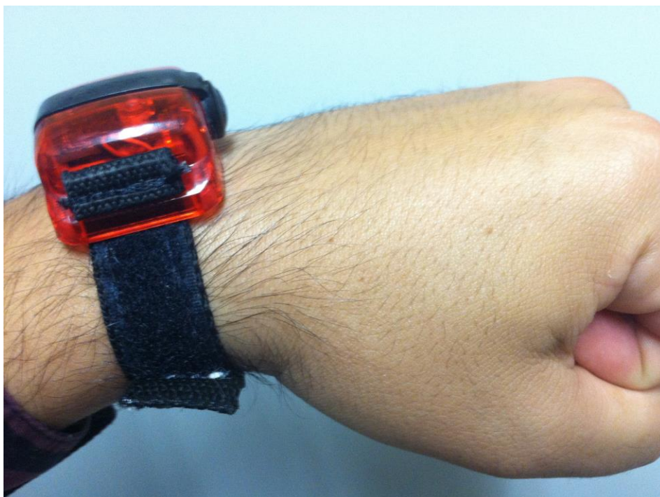
Figura 4. Posição correta do acelerômetro para fixação ao pulso.
