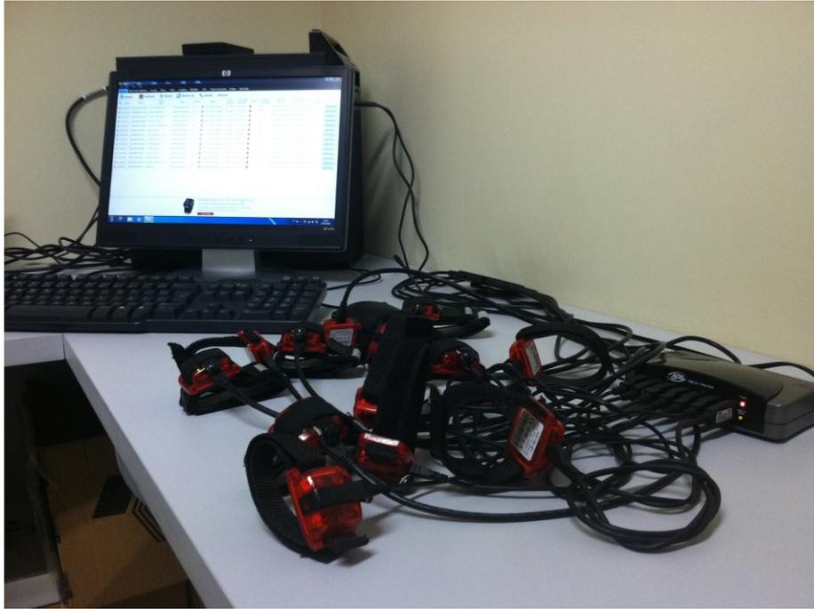
**Figura 5.** Acelerômetros conectados para download dos dados.
