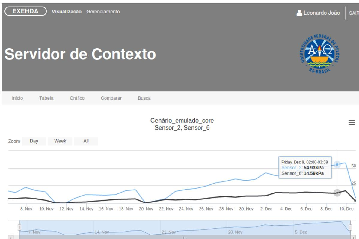
Figura 23 – Visão Gráfica Parcial dos Níveis de Tensão de Água do Solo Utilizados
