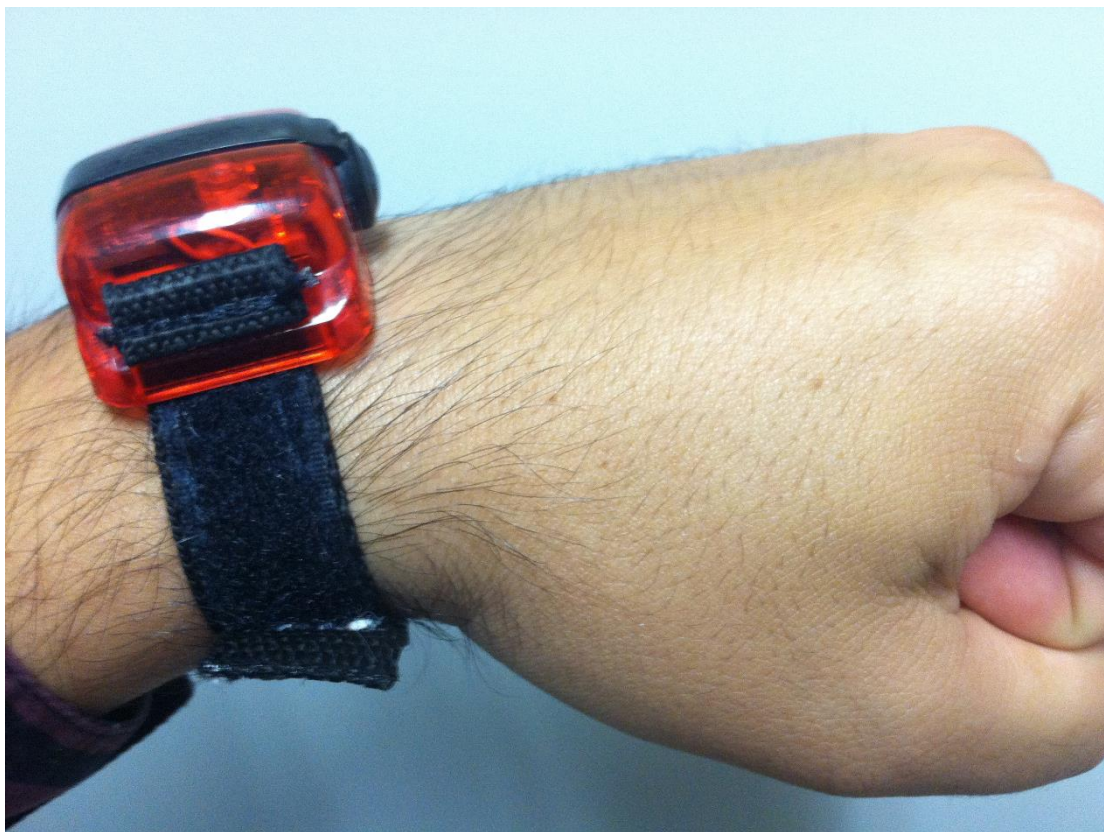
Figura 3. Posição correta do acelerômetro para fixação ao pulso.
