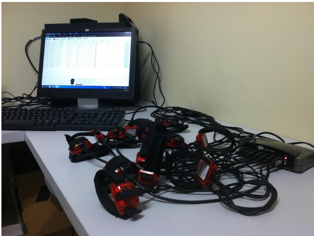
Figura 4. Acelerômetros conectados para download dos dados.
