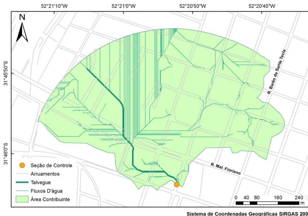
**Figura 10 - Disposição do talvegue e de fluxos d'água na área analisada.**
