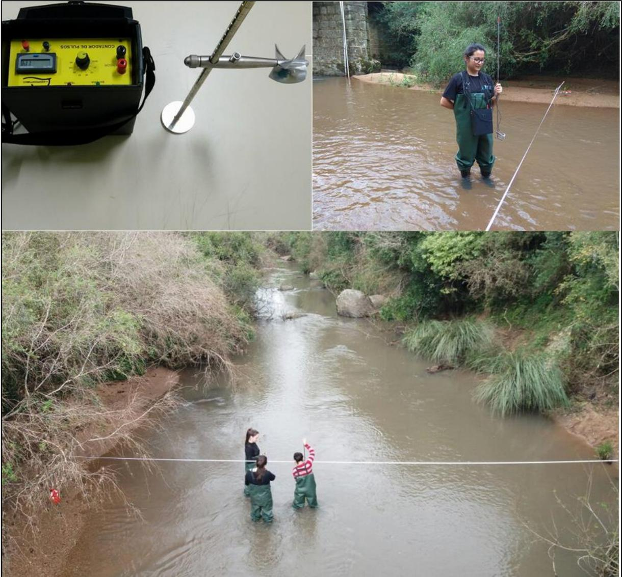
Figura 7 – Utilização de Micromolinetete para medição de velocidade de água realizada a vau na seção de controle da BHAC
