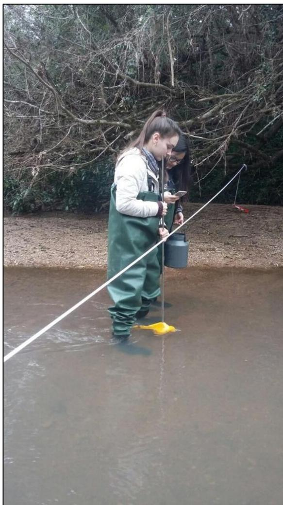
Figura 9 – Amostragem de sedimento em suspensão realizada a vau com o amostrador USDH-48 (AMS-1) na seção de controle da BHAC
