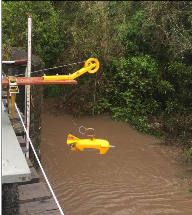
Figura 10 – Amostragem de sedimento em suspensão realizada com o amostrador USDH-59 (AMS-2) e com o auxílio do guincho sobre a ponte na seção de controle da BHAC
