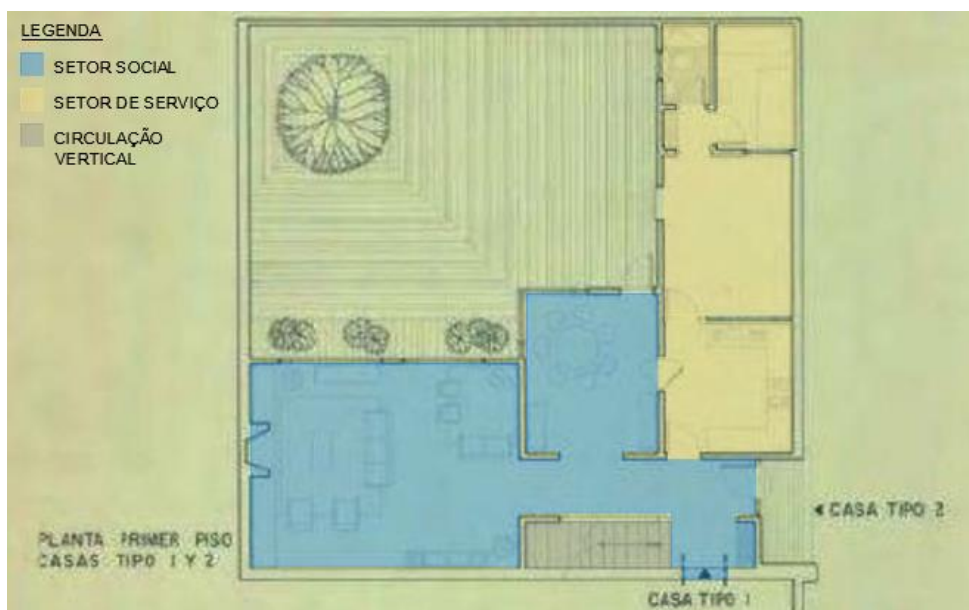
Figura 187 – Planta baixa do pavimento térreo das casas tipo 1 e 2 . Zoneamento. Fonte: Edição da autora sobre imagem disponível em O'BYRNE OROZCO e ÁNGEL SAMPER, 2012, p. 151.
