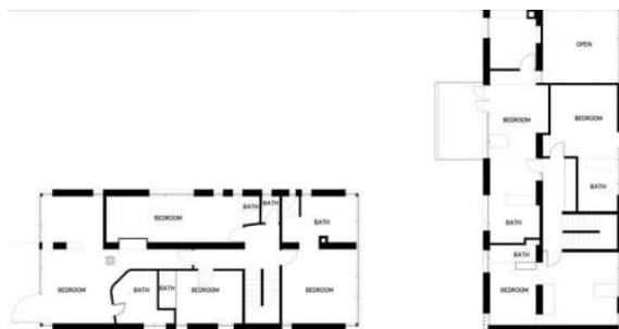
Figura 18 – Vãos diferentes e abóbodas apoiadas sobre três paredes portantes paralelas. Casas Jaoul, 1951.
