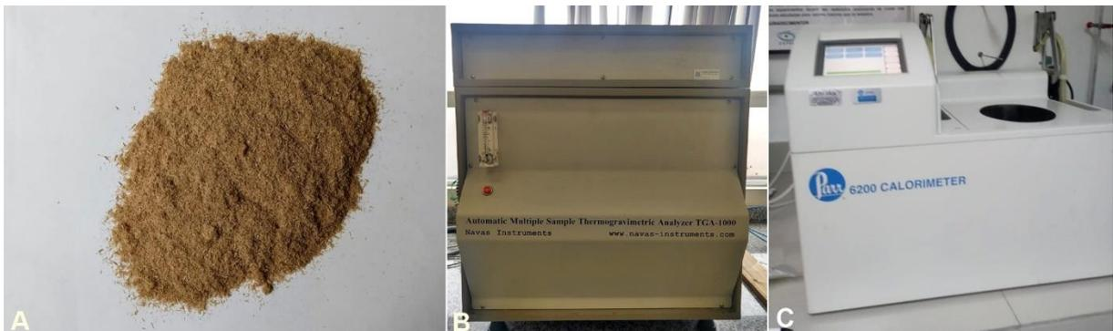
Figura 9 - Madeira moída (A) e equipamentos TGA (B) e Bomba calorimétrica (C). Fonte: Autor, 2021.
