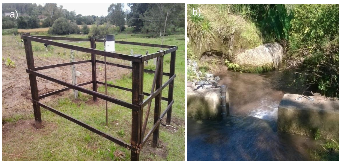
Figura 12 -Monitoramento hidrológico realizado na SBHSE, constituído por a) estação pluviométrica e b) sensores de pressão (monitoramento de nível) localizados no exutório da bacia.
