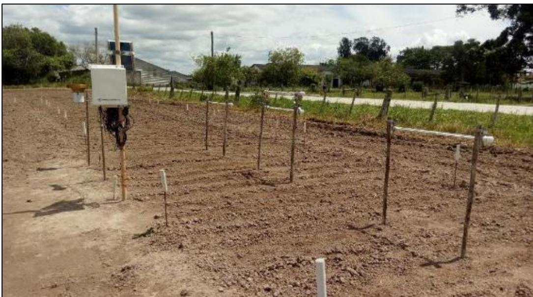
Figura 7. Instrumentos micrometeorológicos ligados ao sistema de aquisição de dados *datalogger*.
