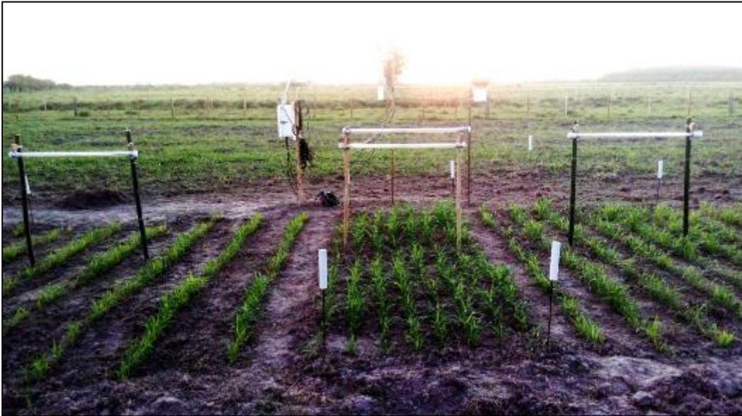
Figura 8. Disposição dos tubos solarímetros.
