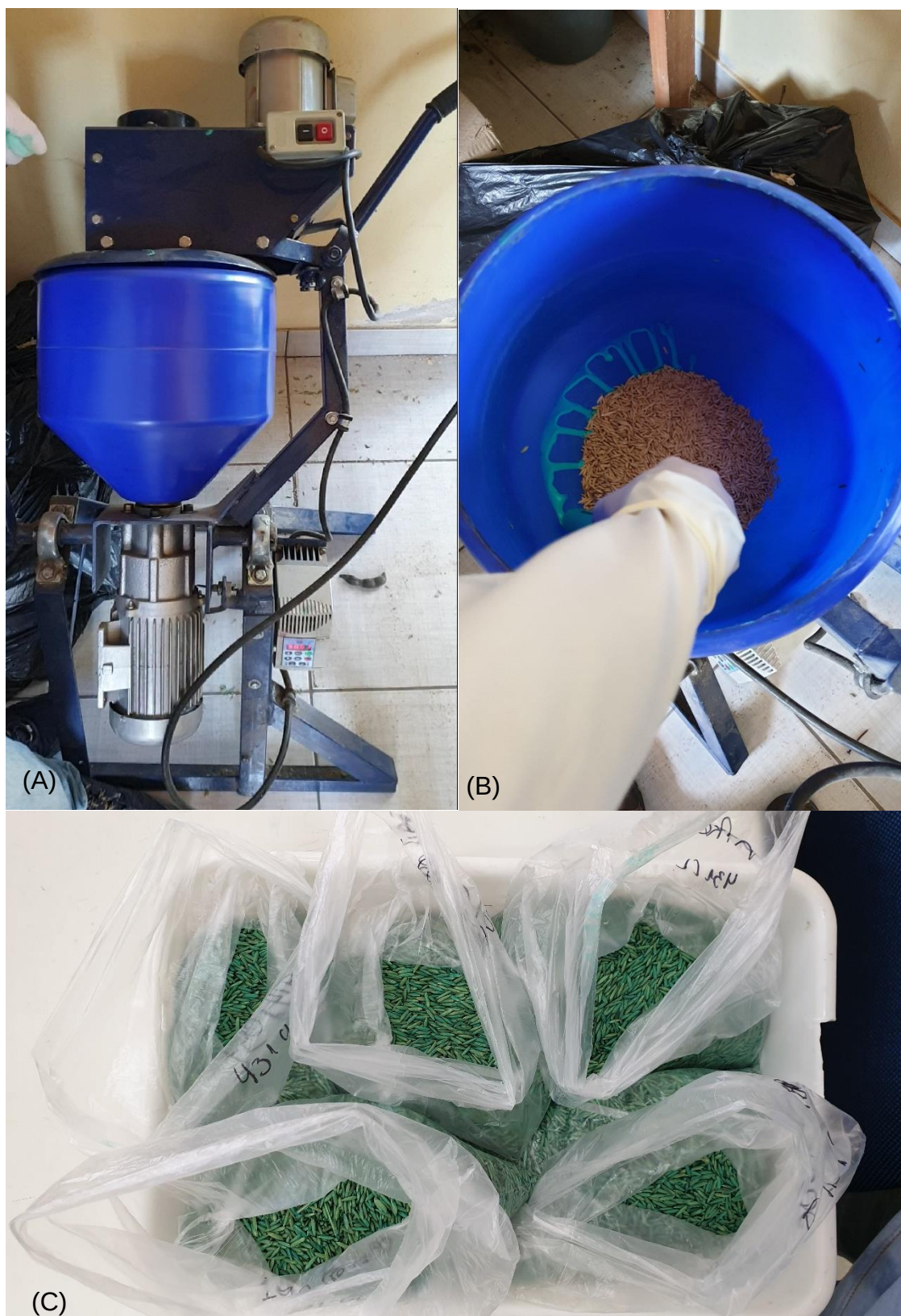
Imagem 1. Realização do tratamento de sementes na máquina laboratorial (A); Aplicação da calda (B); Secagem natural das sementes após o tratamento (C). Pelotas, 2021.
