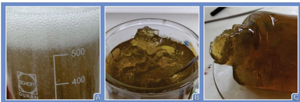
Figura 11 - (A) Reação de gelificação durante tentativa de obtenção de polpa celulósica a partir da alga *Gigartina skottsbergii*; (B) Início da formação de hidrogel durante filtragem; (C) Hidrogel algal.
