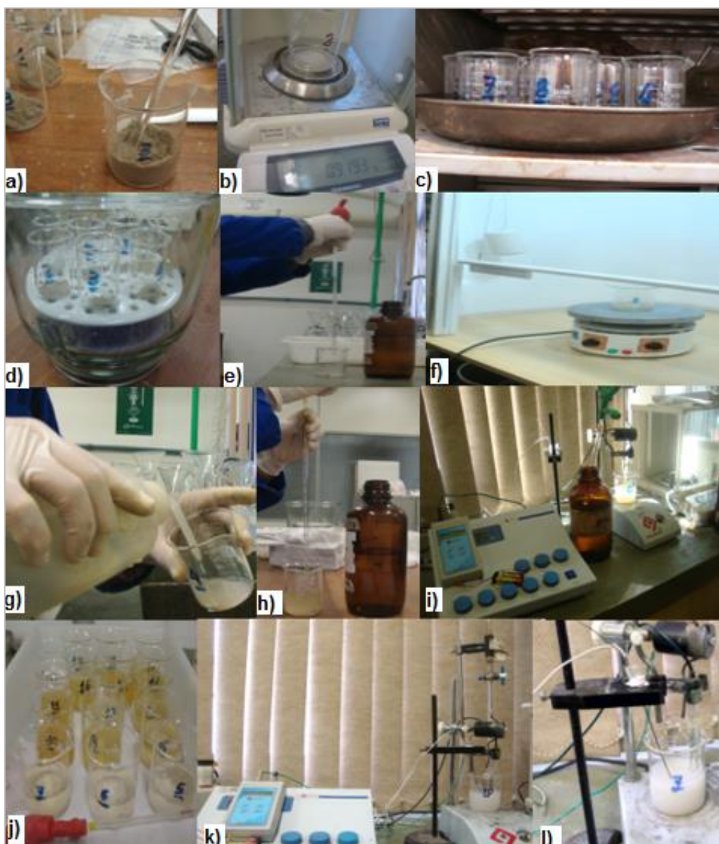
Figura 93 – Fotografias dos procedimentos para obtenção dos perfis de cloreto: a); homogeneização das amostras; b) pesagem em balança analítica; c) secagem em estufa; d) esfriamento em dessecador; e) aplicação de solução de ácido nítrico; f) fervura; g) lavagem paredes recipiente pós fervura; h) aplicação de hidróxido de sódio; i) correção de pH; j) amostras prontas para a potenciometria; k); l) potenciometria.
