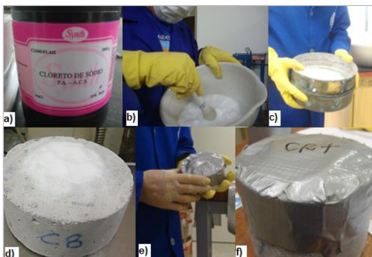
Figura 87 – Fotografia dos procedimentos para contaminação dos CPs com NaCl: a) recipiente de cloreto de sódio; b) trituração; c) moagem peneira; d) CPs com 10g de sal; e) vedação do contaminante f) CPs contaminado e vedado.
