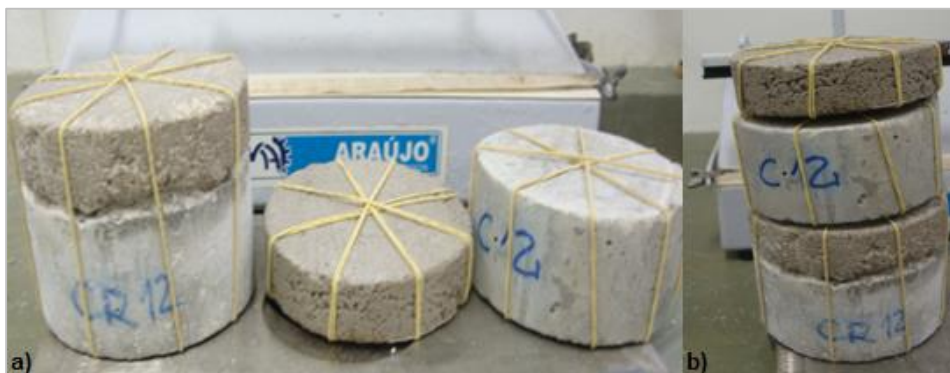
Figura 81 – Fotografia da colocação dos espaçadores de borracha nos CPs do conjunto. Fonte: Autor.
