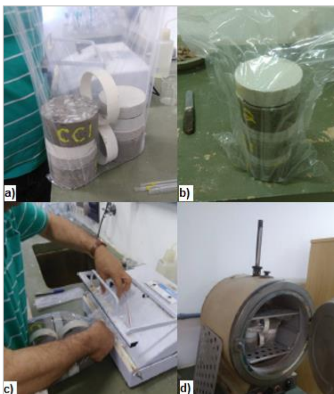
Figura 62 – Fotografias com procedimentos para uniformização dos CPs: a) conjunto 1; b) conjunto 2; c) lacramento com guilhotina térmica; d) colocação em estufa 50°C.
