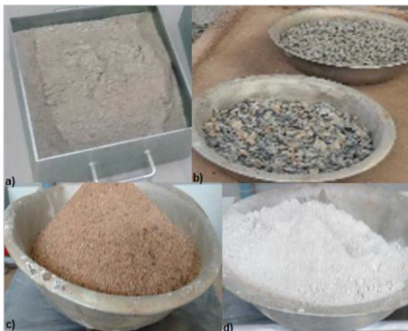
Figura 68 – Amostras dos materiais constituintes dos CPs: a) cimento Portland; b) brita nº 1 e nº 0; c) areia; d) cal hidratada.
