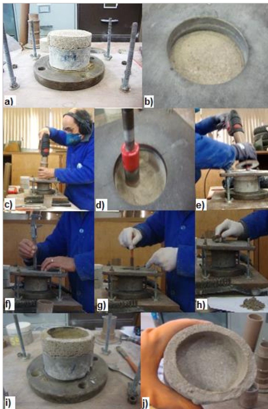
Figura 67 – Fotografias do processo de extração de amostras pulverizadas dos CPs de concreto revestido: a); b) fixação do CP no equipamento de extração; c); d); e) extração com a furadeira elétrica; f) controle de espessura de camada com paquímetro; g) juntar material em pó para retirar; h) remover material em pó; i); j) revestimento em argamassa com extração pronta.
