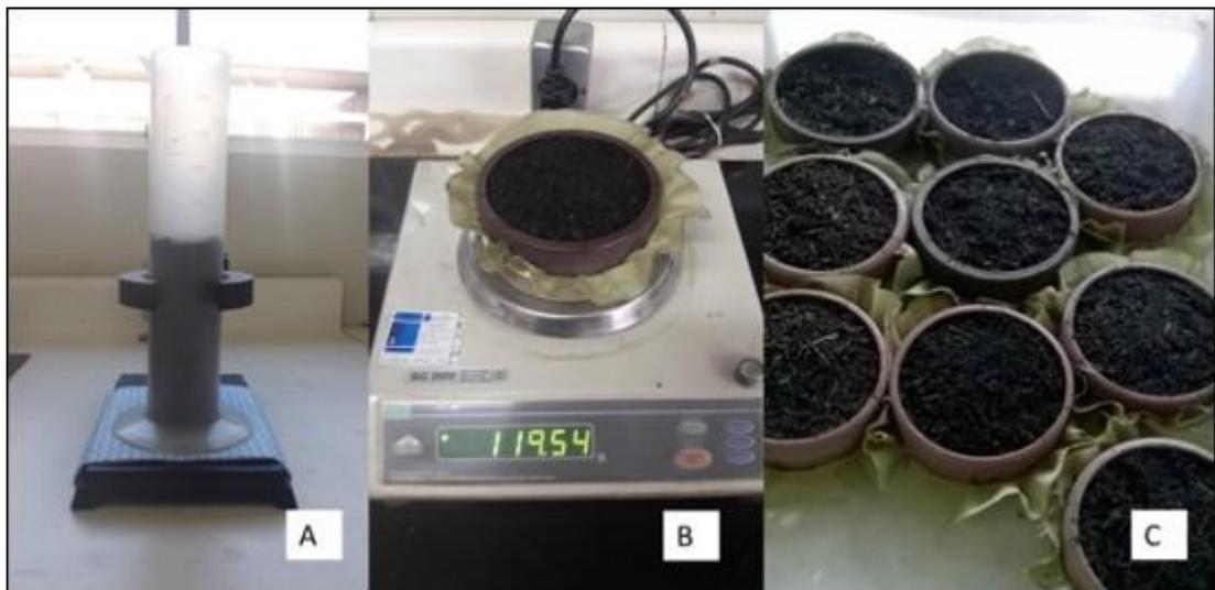
**Figura 7-** Amostra alocada no suporte para proveta a 10 cm de altura (A), pesagem da amostra em balança de precisão (B) e materiais postos a saturar imersos em água a 1/3 da altura do cilindro.
