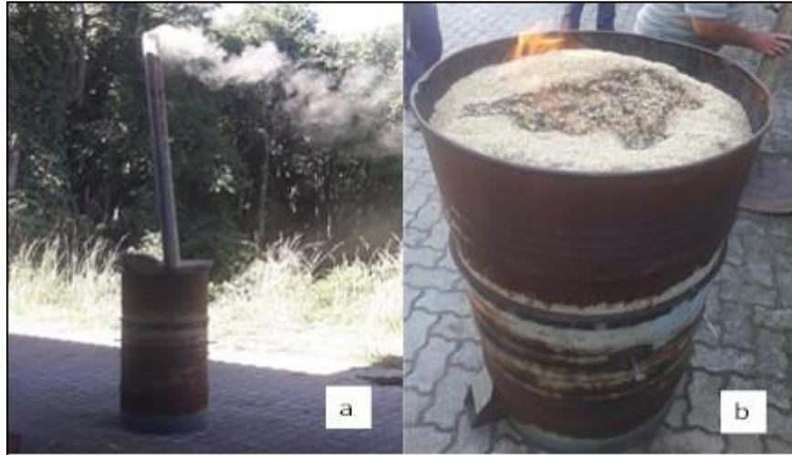
**Figura 6-** Carbonizador (a); casca de arroz carbonizando (b).
