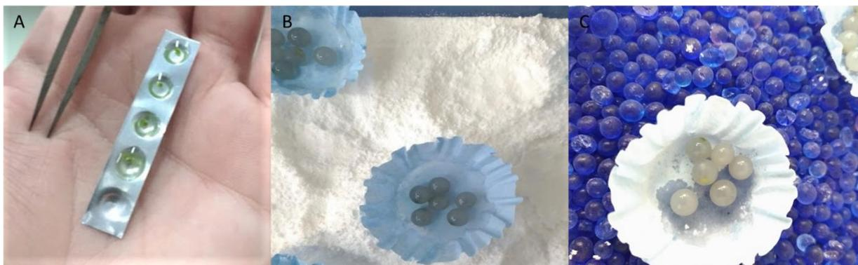
Figura 2 – A: cápsula em crioplaca de alumínio; B: dessecação de cápsulas sobre  $\text{CaCl}_2$ ; C: dessecação de cápsulas sobre sílica-gel.
