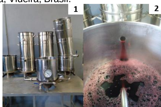
Equipamento empregado na extração do suco (1) e suco fluindo na panela pulmão para homogeneização e envase (2).
