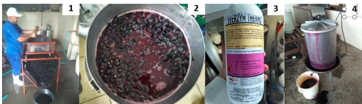
Desengace manual das bagas (1), aquecimento até 50°C e enzimação (2), enzima termorresistente (3) e prensagem para separação do bagaço em prensa hidrostática (4).
