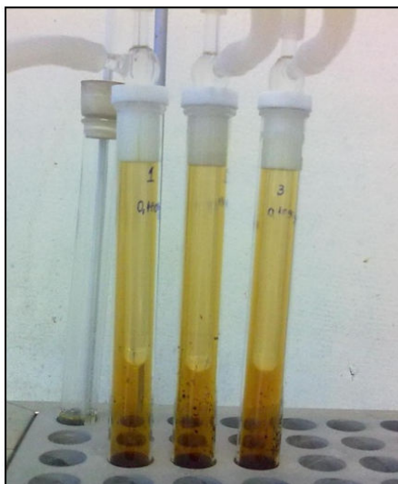
Figura 19 – Processo de decomposição ácida utilizando sistema com dedo frio.
