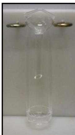
**Figura 8.** Dispositivo de quartzo utilizado na MIC como suporte para as amostras.
