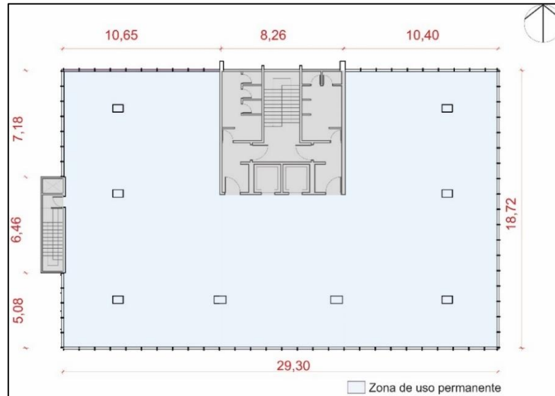
Figura 29 - Planta baixa do pavimento tipo Fonte: AUTORA, 2021
