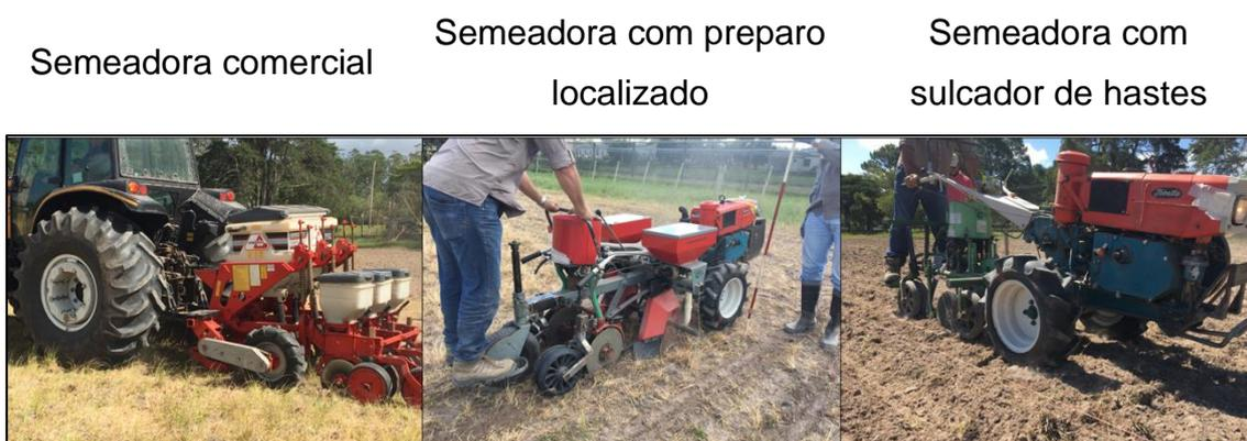
Figura 3 – Semeadoras utilizadas no experimento com o milho. EMBRAPA-ETB, 2018.
