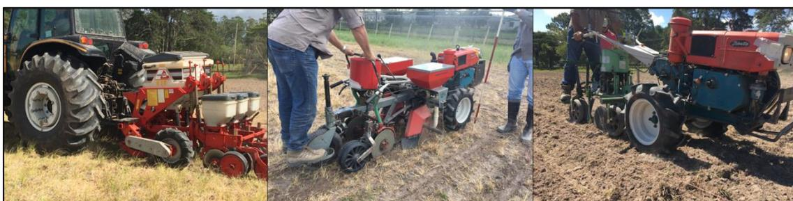
Figura 10 – Semeadoras utilizadas no experimento com a soja. EMBRAPA-ETB, 2018.
