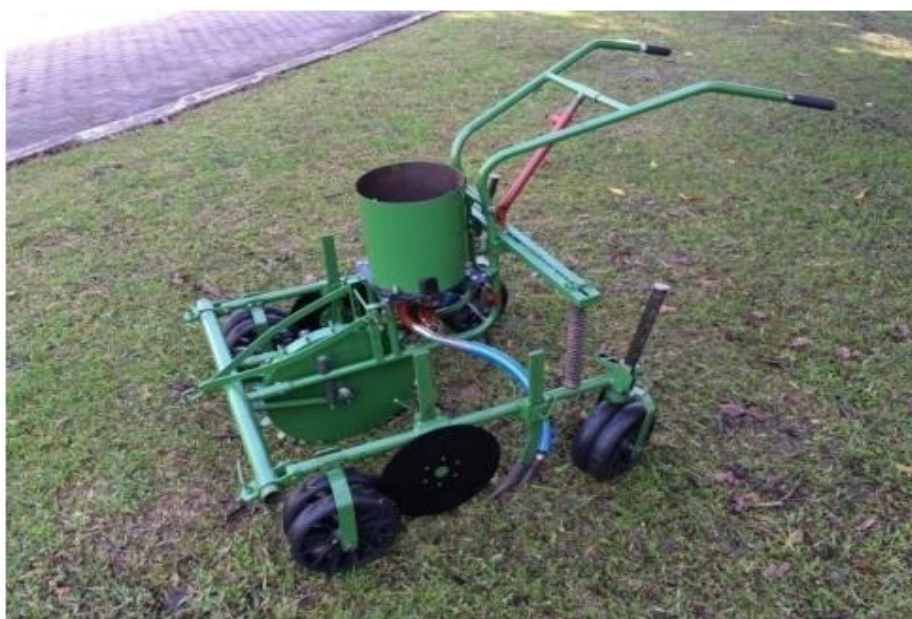
Figura 3. Semeadora agroecológica de tração animal e mecânica. Fonte: MACHADO et al., 2017.
