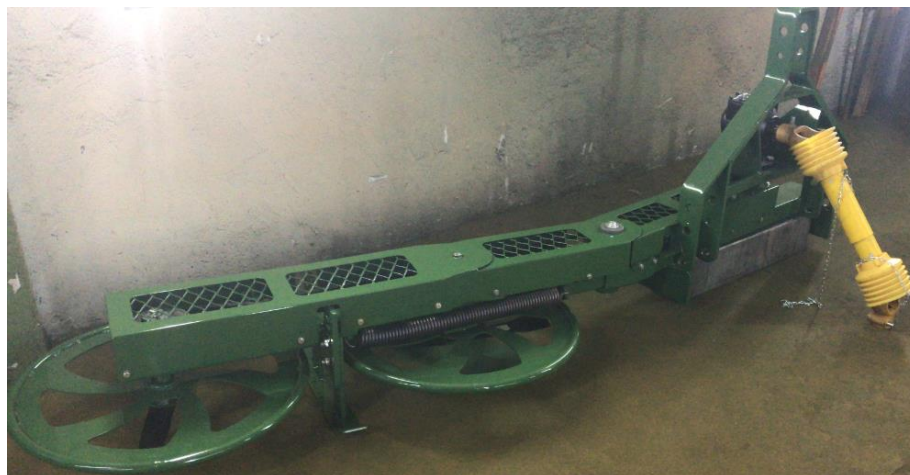
Figura 14. Roçadora mecânica para limpeza sob a copa de pomares. Fonte: MACHADO et al., 2017.
