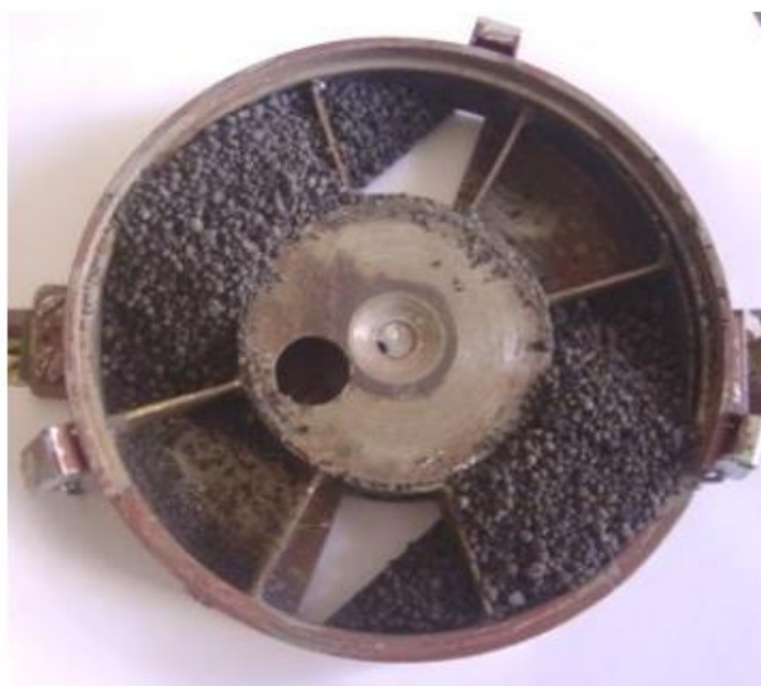
Figura 6. Dosador de adubo de duas saídas. Fonte: MACHADO et al., 2017.
