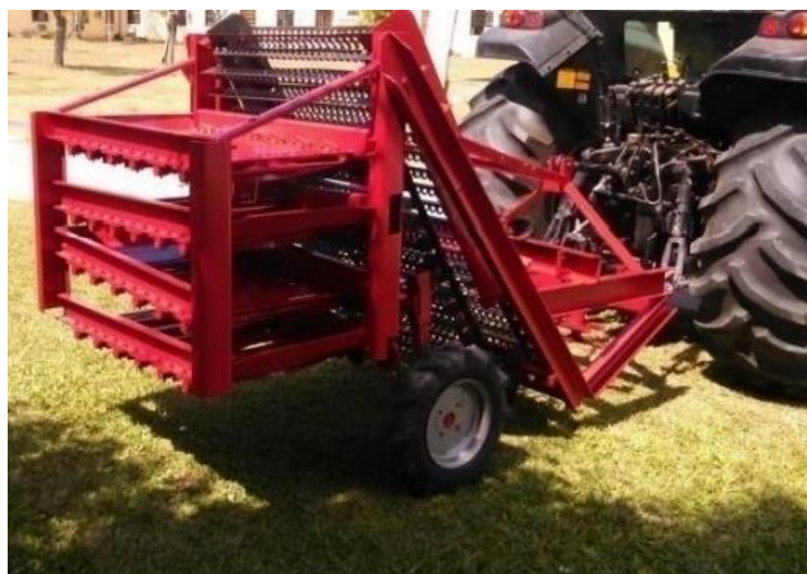
Figura 10. Colhedora – beneficiadora de cebolas. Fonte: MACHADO et al., 2017.
