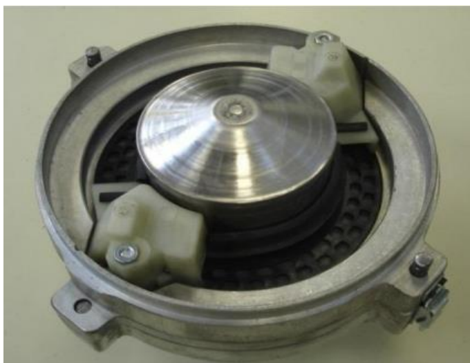
Figura 7. Dosador de sementes de milho e feijão com dupla saída. Fonte: MACHADO et al., 2017.
