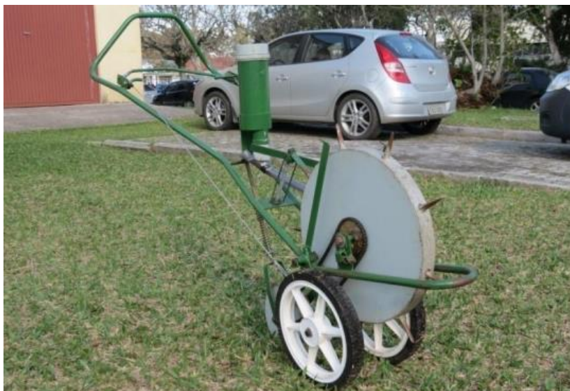
Figura 8. Semeadora punch planter de uma linha. Fonte: MACHADO et al., 2017.
