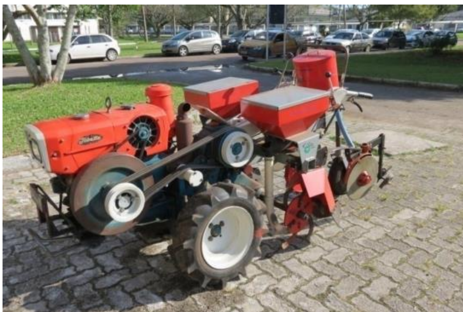
Figura 4. Semeadora com sulcadores rotativos. Fonte: MACHADO et al., 2017.
