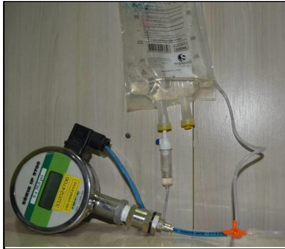
Figura 15 - Manômetro digital conectado ao equipo
