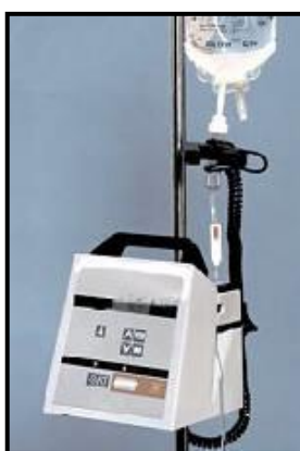
Figura 4 - Sistema de infusão com controle de escoamento automático. Fonte: Brasil (2010).
