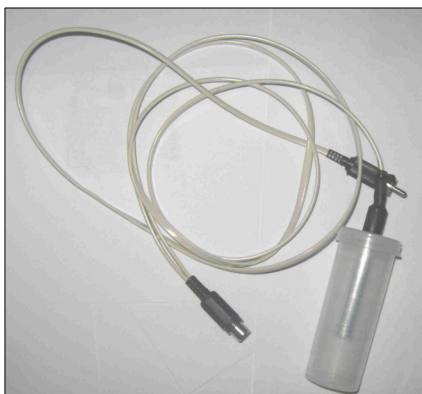
Figura 30: Sensor de Temperatura 1-Wire DS18B20 Desenvolvido para Emprego Submerso em Líquido (Água)
