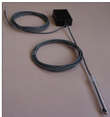
Figura 36: Sensor de Presença de Luz Desenvolvido com o LDR Encapsulado em Tubo Plástico Externo ao Circuito
