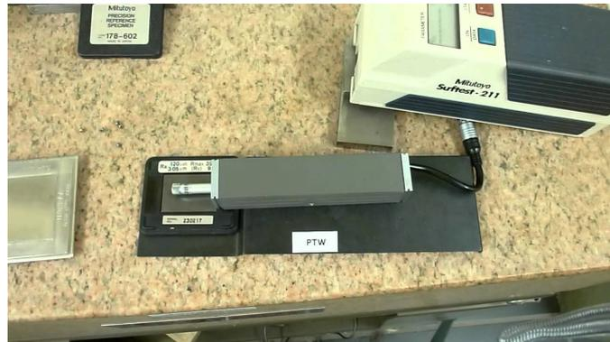
Figura 9: Rugosímetro Mitutoyo SurfTeste Similar ao do curso de Mecânica IFSul –Pelotas, utilizados para os ensaios de rugosidade.
