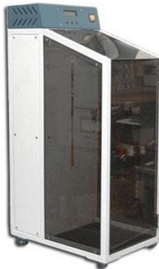
Figura 5- Equipamento *Dip-Coating*
