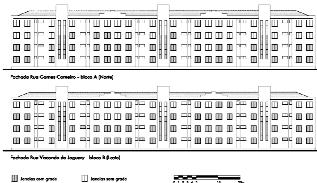
Figura 37: Janelas com grades nas fachadas externas – Conjunto Porto.
