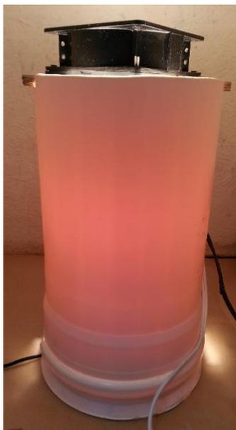
Figura 9 - Célula de reação utilizada para o ensaio de fotodegradação.
