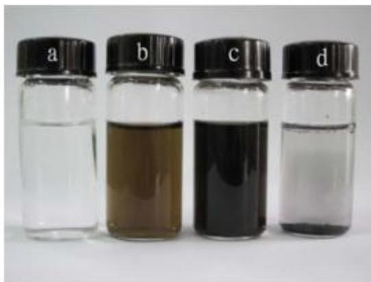
Figura 10 – Fotografia de soluções aquosas de (a) Álcool polivinílico (PVA) puro, (b) PVA + óxido de grafeno disperso, (c) PVA + óxido de grafeno reduzido disperso e (d) PVA + grafite disperso, tudo após três semanas (WANG *et al.*, 2011).
